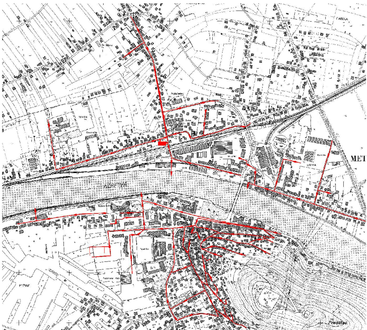
Slika 4. Postojeći (mješoviti) sustav odvodnje otpadnih voda
